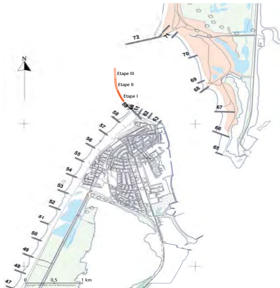
Figur 16: Principskitse af indsnævring mellem hofde 58/59 og hofde 72 i 3 etaper i takt med udviklingen.
