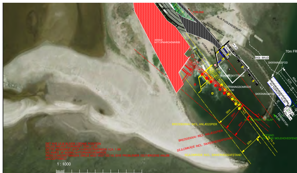
Tegning nr. 3.3 viser alternativ 1. Ved at man skal runde den sydvestlige mole, vil selve indsejlingen foregå mere i strømmen. (3.2) (havnecon 2015)
