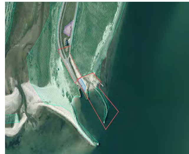
Tegning nr. 8.2 viser arbejdsområder under de forskellige anlægsfaser i forhold §3 område. Fuldt optrukket rød: arbejdsområde ved uddybning, anlæggelse af færgeleje, blåskravet område: skur og maskinplads ved anlæggelse af færgeleje og mole, rødstiplet område: arbejdsområde i landområdet, lillaskaveret midlertidig Pendler P-plads i anlægsperioden (8.4)(Cowi, 2015).
