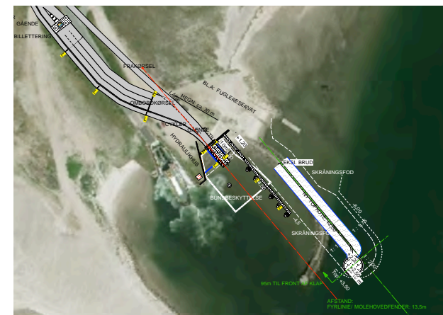
Tegning nr. 10.3 viser moleudretningen, der forbedrer indsejlingen. Viser desuden foreløbig placering af fyr (rød linje). Endelig placering fastsættes i detailprojekt (10.9) (Havnecon, 2014)
